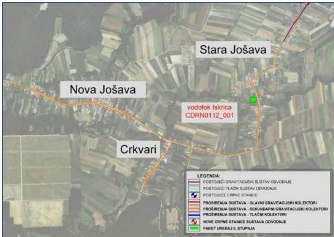
Slika 2.9 Rješenje izgradnje sustava odvodnje s paket uređajem za naselja Stara Jošava, Crkvari i Nova Jošava
